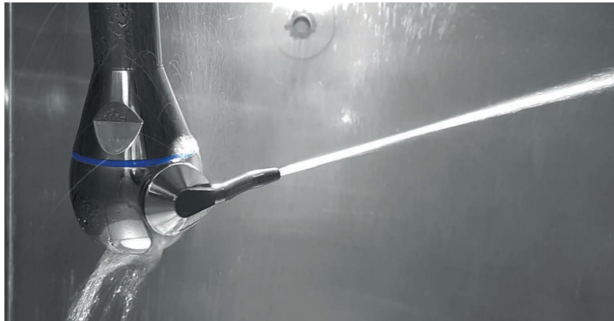
Der adaptive Jet Cleaner auf dem Mobile Cleaning Device für die Tankreinigung im Einsatz. The adaptive jet cleaner on the Mobile Cleaning Device for tank cleaning in use.
