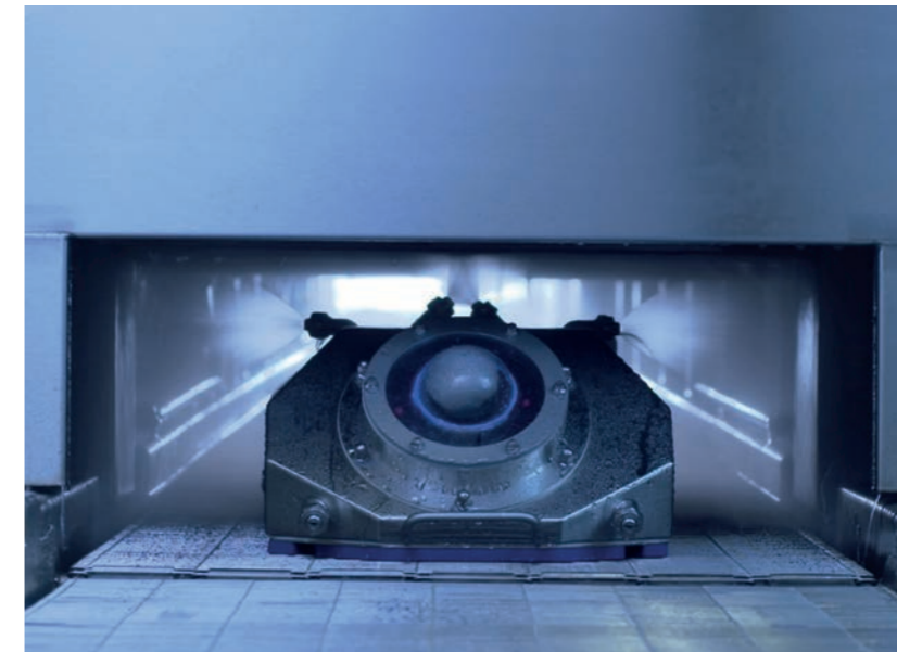
Ein Modell des Reinigungsroboters bewegt sich über das Förderband auf dem Produktweg durch die Produktionsanlage und reinigt diese von innen. A robot variant moves over the conveyor belt on the product line and cleans it from inside the production plant.
