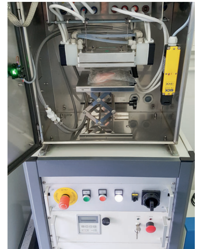
Blitzlichtbehandlung von verpacktem Frischfleisch in einer Laboranlage
