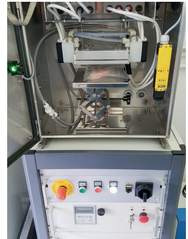
Blitzlichtbehandlung von verpacktem Frischfleisch in einer Laboranlage
