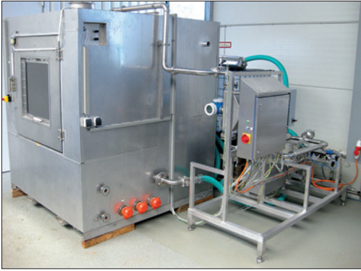
Der verwendete Versuchsstand mit Waschkabine am Fraunhofer AVV und sein Funktionsschema
