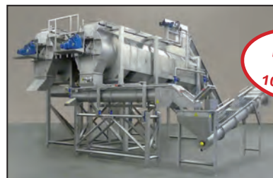
FTNON DCC® Dampfpanlage für die Zubereitung von Kartoffeln und Gemüse.
