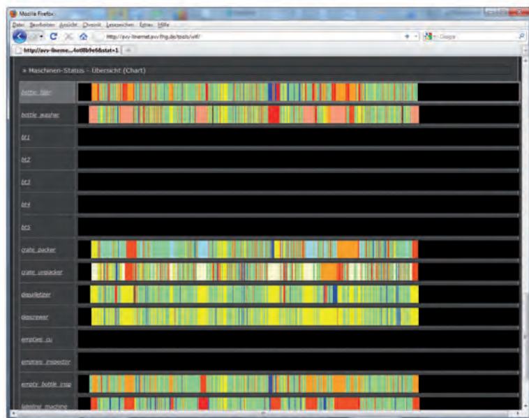
Ein Gantt-Chart zeigt grafisch den zeitlichen Zusammenhang aller Zustände der beteiligten Maschinen in einer Abfülllinie über einen definierten Zeitraum
