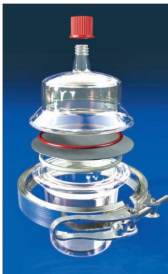
Abb. 3: Glas-Migrationszelle zur Untersuchung von Migrationen in Flüssigkeiten und auf Tenax (Entwickler: FABES/Gaßner Glastechnik)
