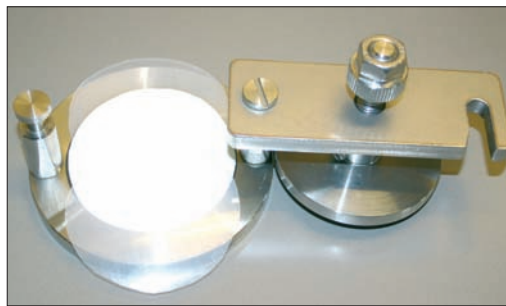
Abb. 2: Stahl-Migrationszelle zur Untersuchung von Migrationen auf feste Schichten wie LDPE-Folie oder Karton (Entwickler: FABES/Gaßner Glastechnik)
