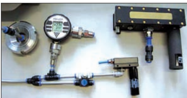
Die verwendete Prüfkammer des Fraunhofer AVV für die Differenzdruckmessungen mit Messzubehör
