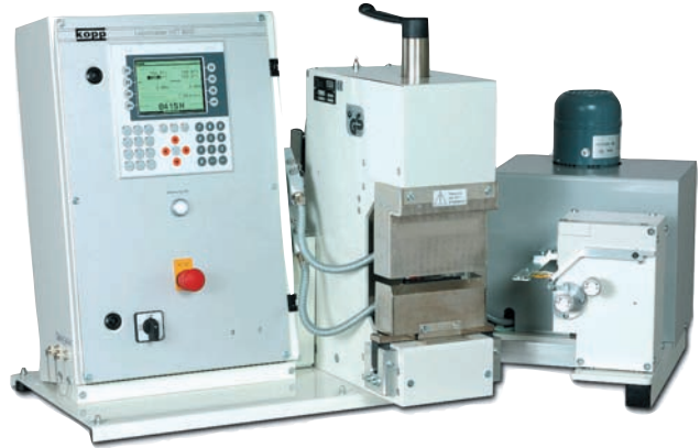
Der Labormaster HCT 3000 von Kopp ermittelt die Warmnahtfestigkeit anhand der erforderlichen Trennkraft
