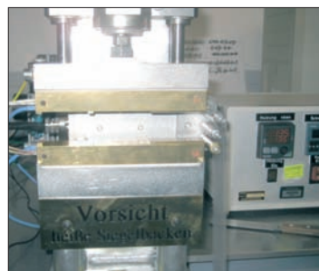
Brügger Feinmechanik (li.) und Treofan (re.) greifen für die Hot-Tack-Messung auf den Trennweg als Messgröße zurück
