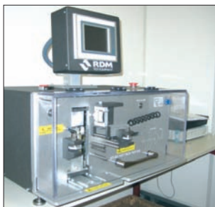
Die Hot-Tack-Tester von RDM Test Equipment (li.) und DTC (re.) messen die Trennkraft der Siegelnaht
