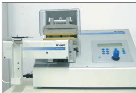
Brügger Feinmechanik (li.) und Treofan (re.) greifen für die Hot-Tack-Messung auf den Trennweg als Messgröße zurück
